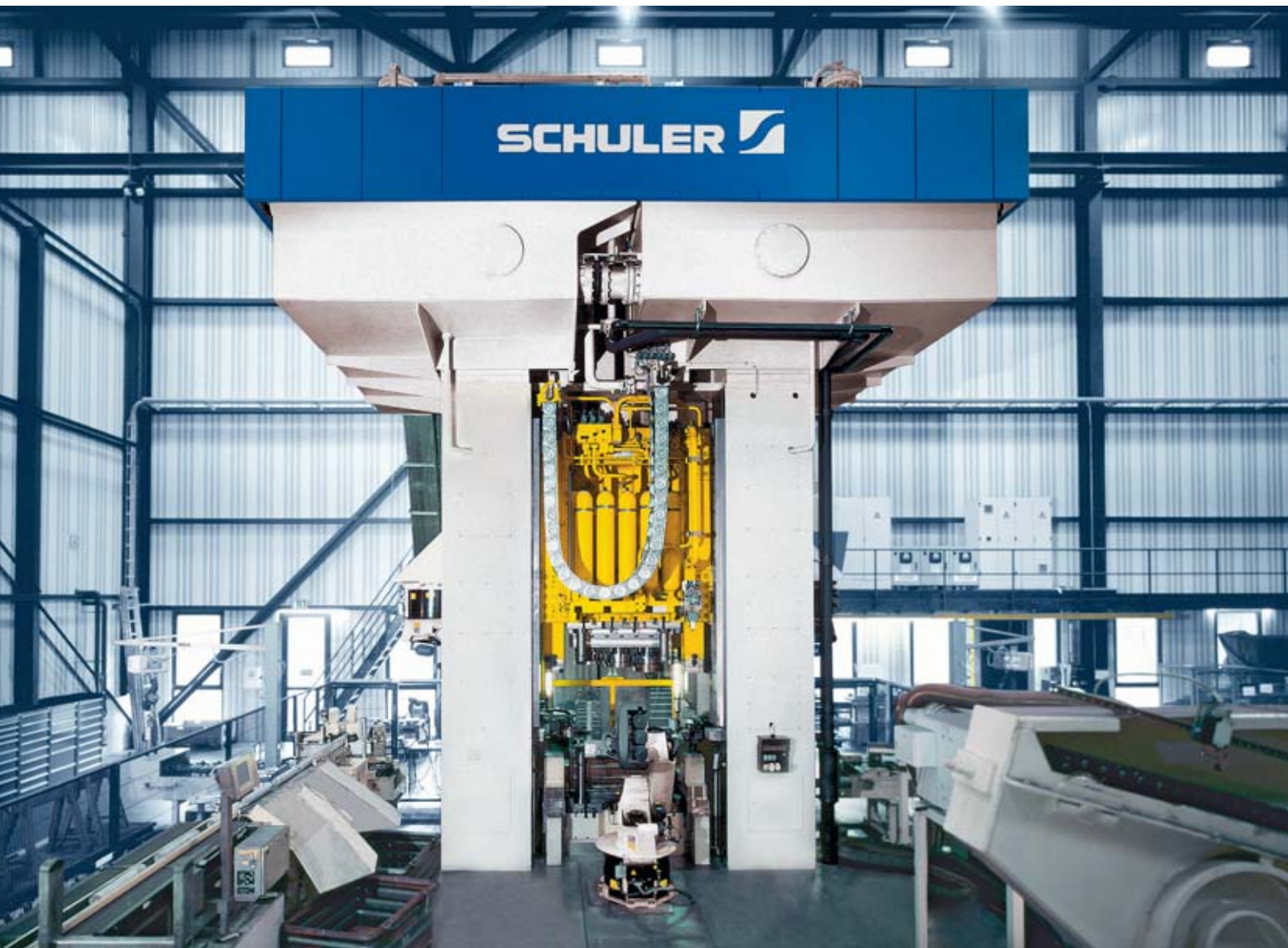
Mehrstufige hydraulische Kalt- fließpresse mit 25 000 kN Presskraft. Bilder: Schuler
