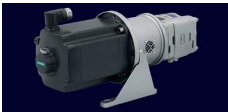
Eine Servopumpe benötigt Energie nur bei Druckbedarf und verbraucht deshalb deutlich weniger Energie als ein Hydraulikaggregat, das ständig Druck erzeugt.
