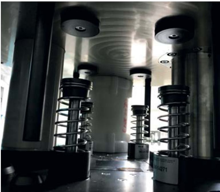
Die Anschlagdämpfer des Release-Caging-Mechanismus.
