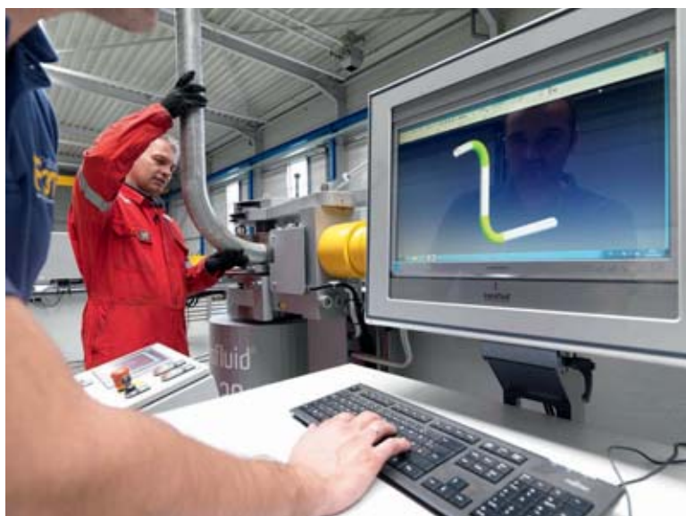
Für den Bau von Schrottpressen liefert Parker Hannifin kundenspezifisch gebogene Rohrsysteme. Im Vergleich zu geschweißten oder verschraubten Komponenten wird damit das Leckagerisiko als auch der Strömungswiderstand in den Rohrleitungen aufgrund glatter Oberflächen reduziert. Bild: Parker Hannifin
