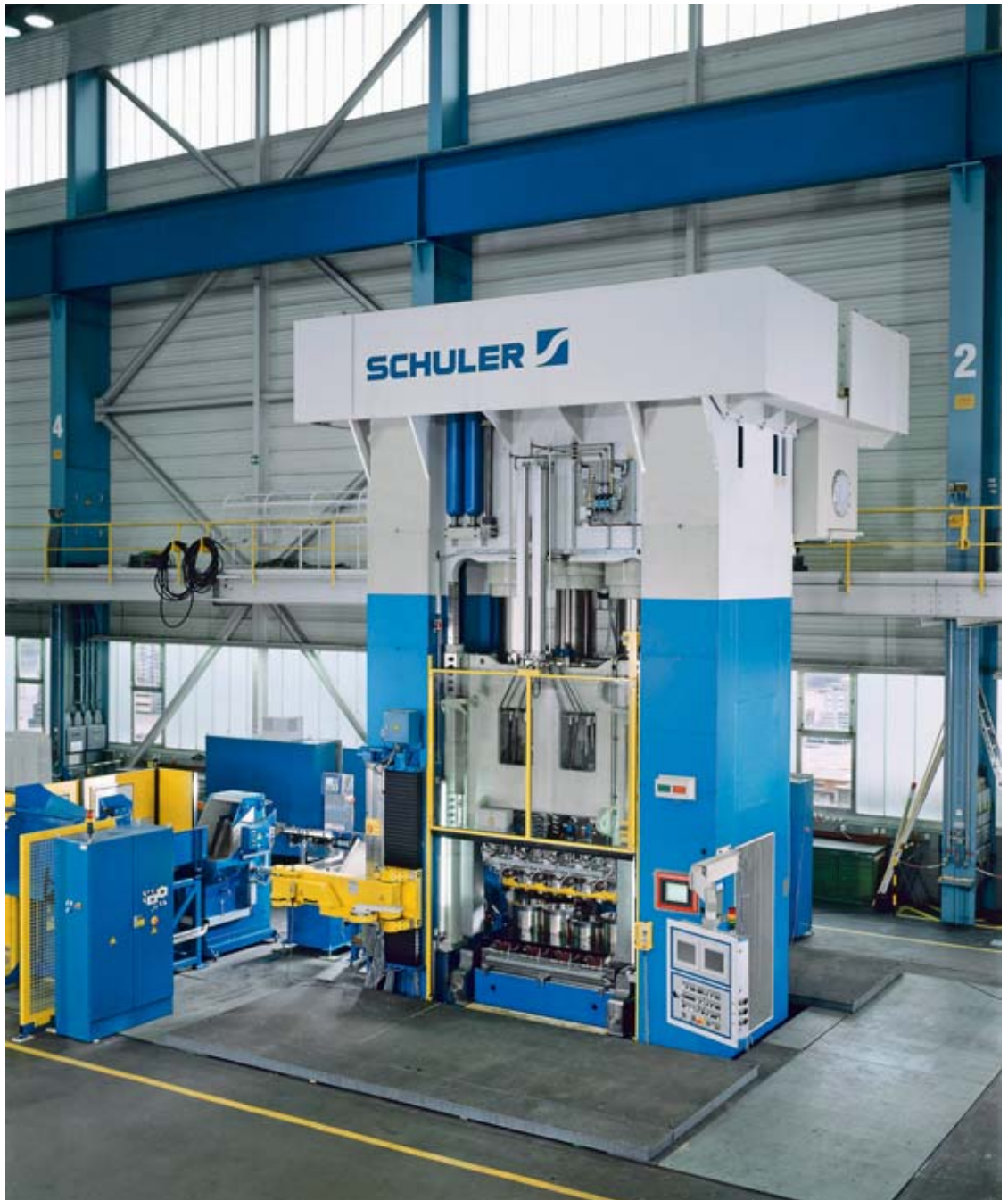
Automatisierte hydraulische 4-Stufenpresse für die Kaltmassivumformung.
