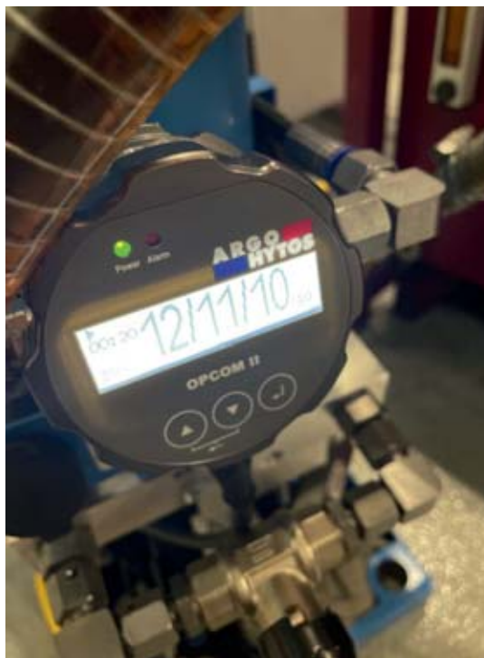
Reinheitsklasse ISO 4406 nach circa 60 min (12/11/10).
