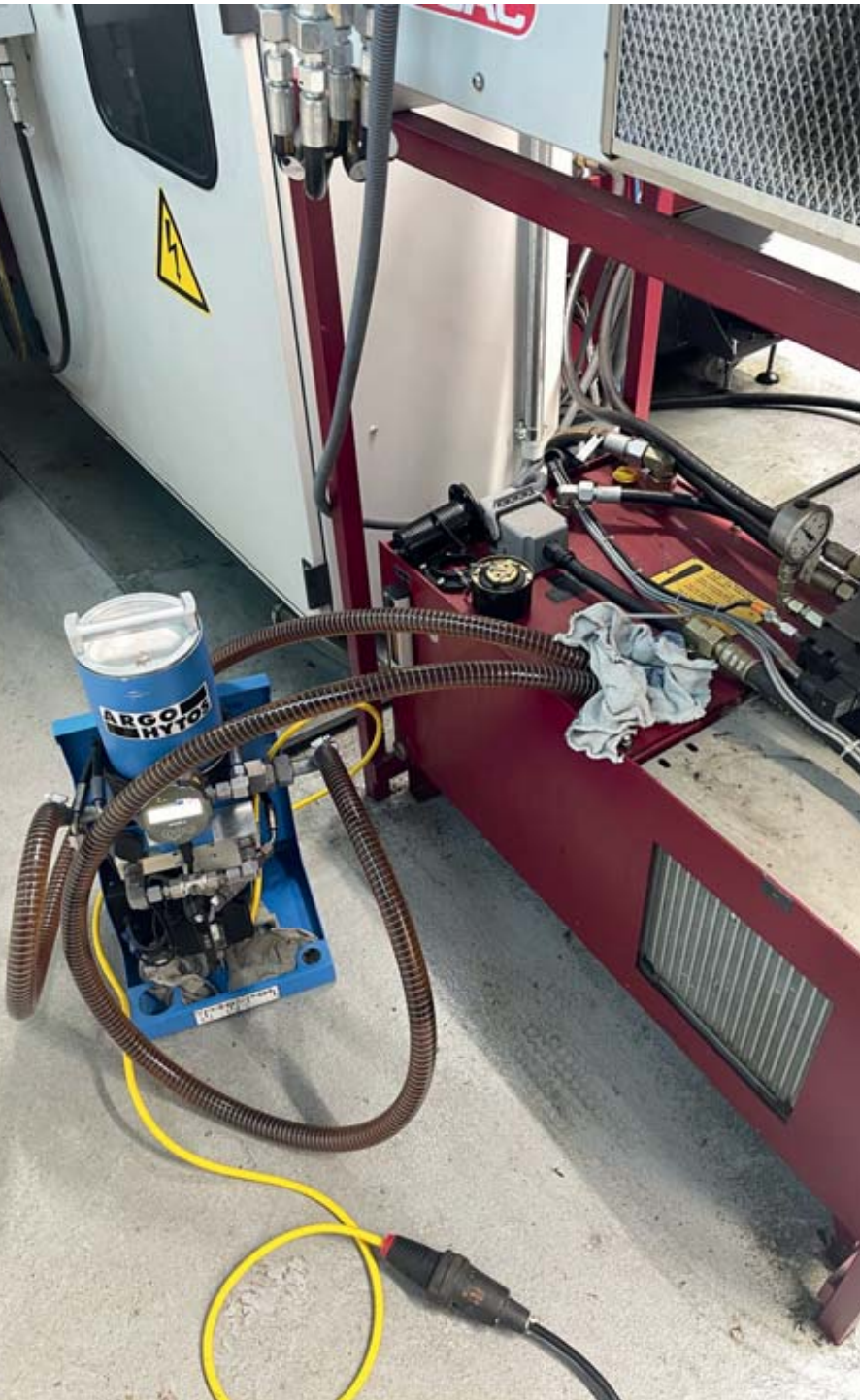
Die Filtereinheit FAPC2 016 im Einsatz an der Drehmaschine.
