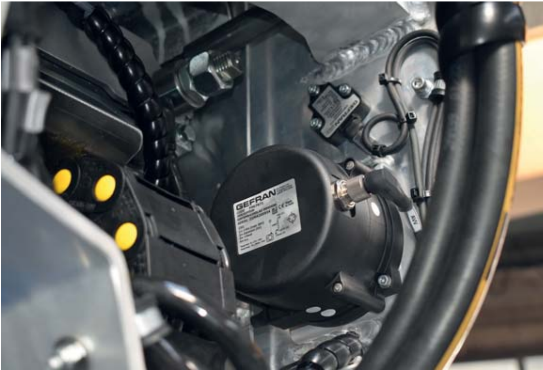
Sicher montiert: Der große Seilzugaufnehmer GSF und der deutlich kleinere Neigungssensor GIB. Bild: Multitel Pagliero
